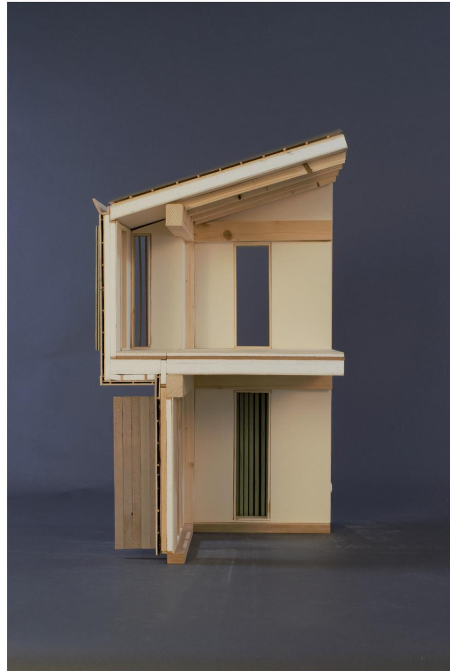
Fig 1.7 : Maquette 1:20 du complexe de façade des logements
