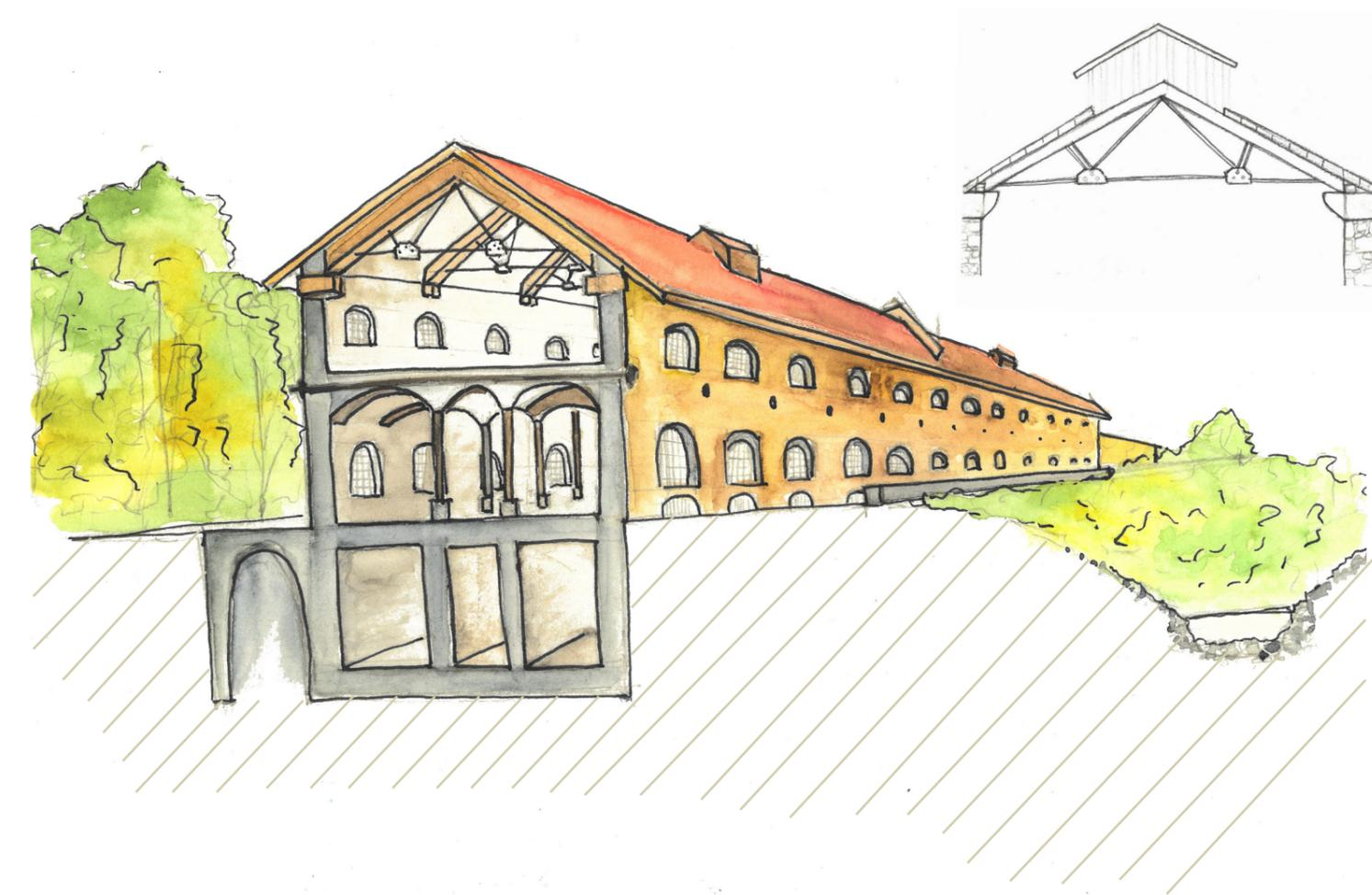
Figure 4.7 : Coupe perspective montrant la structure de la halle marcelline et coupe d'un lanterneau, Maëlle Poussin
