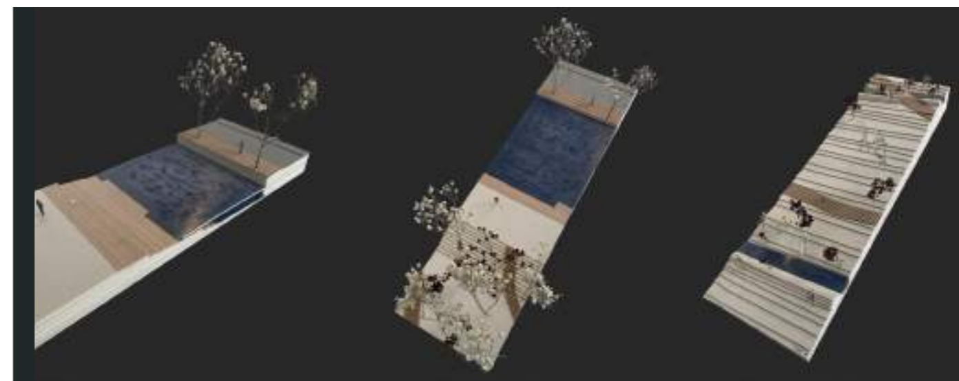
ADOUCCISSEMENT DES DIGUES PAR LA CRÉATION D'UN GRADIN
