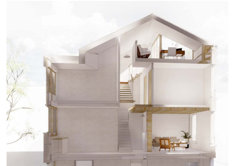
COUPE SUR SURELEVATION DUPLEX RUE
