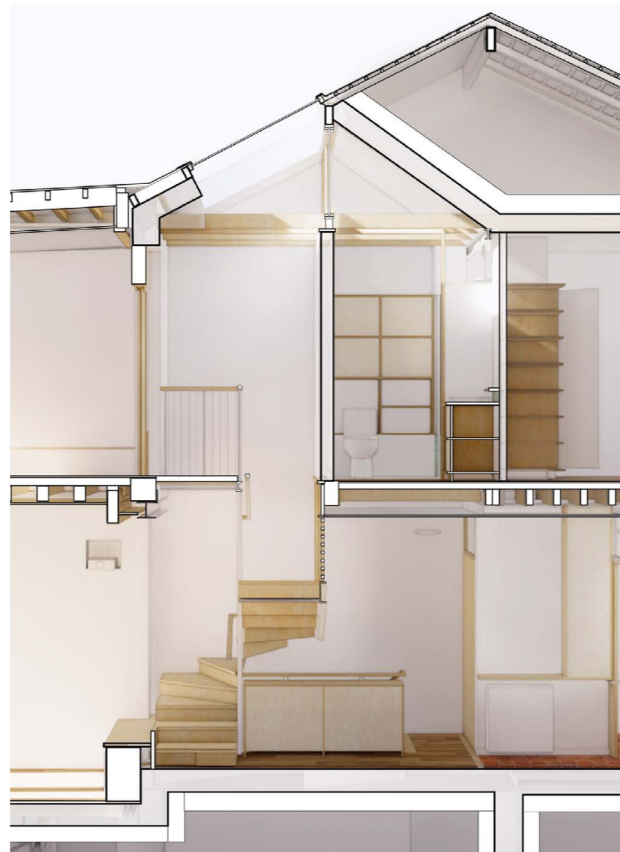
ESCALIER CAVE - Escalier béton ancrée dans le soutènement mitoyen en pierre.
