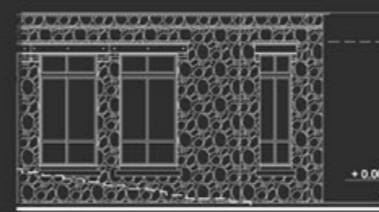
OUVERTURE DU BARREAUDAGE VERTICAL EXISTANT EN ROC COTE COURS
