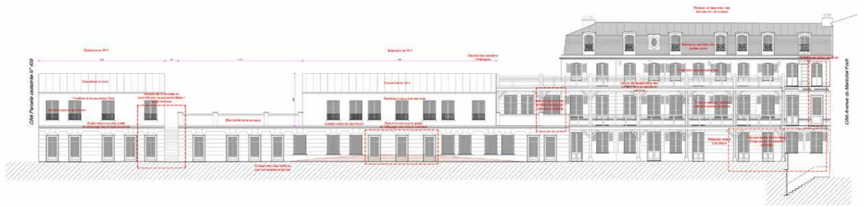
Façade longitudinale de la cour intérieure et relevé des interventions
