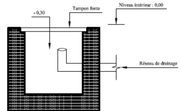
Détail B : Evacuation du réseau de drainage dans la fosse de relevage (Echelle : 1/20)
