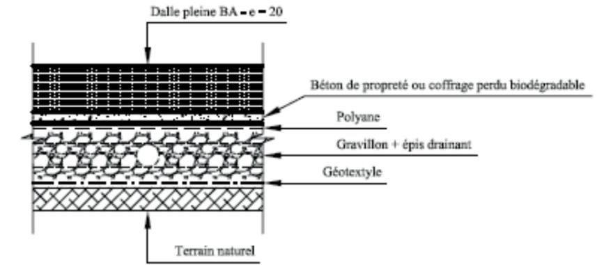
Coupe type sur drainage sous plancher bas sous sol (Echelle : 1/20)
