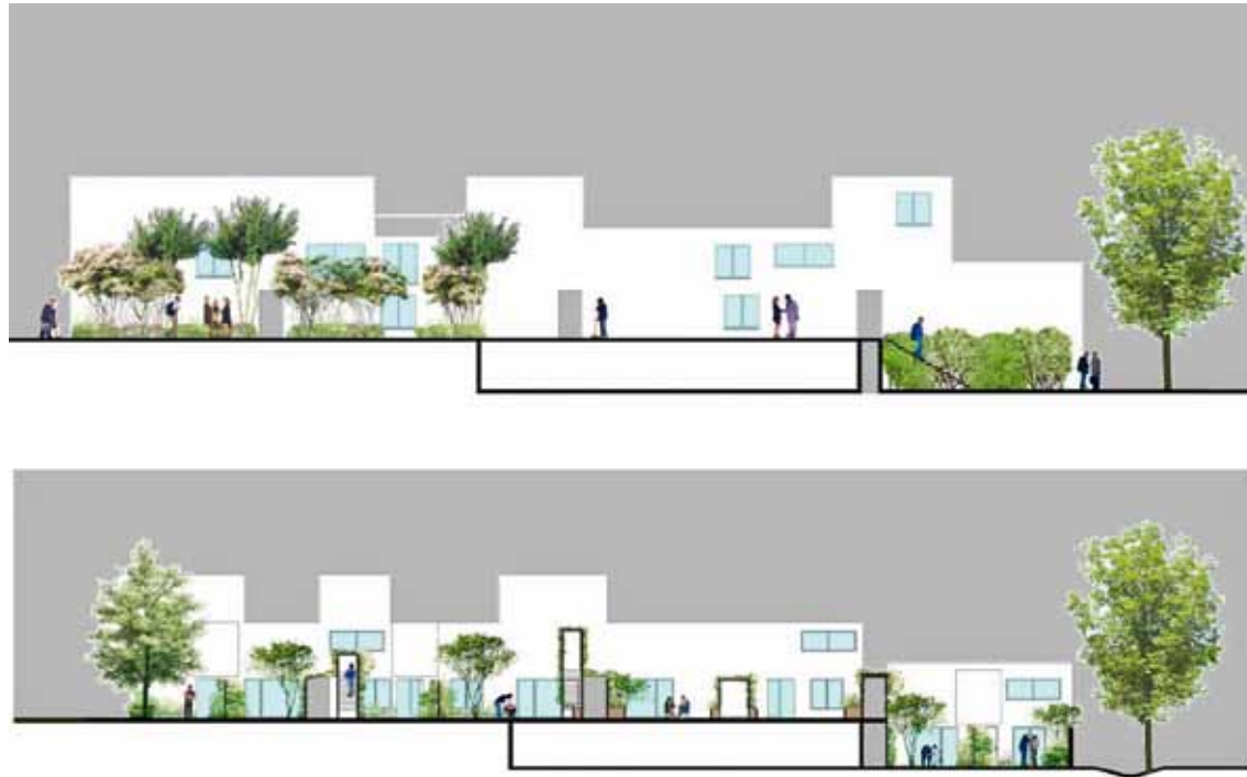
Une bande de 5 maisons, avec coupe sur le parc de stationnement. Les terrassements du parking permettent d'absorber la pente du terrain.
